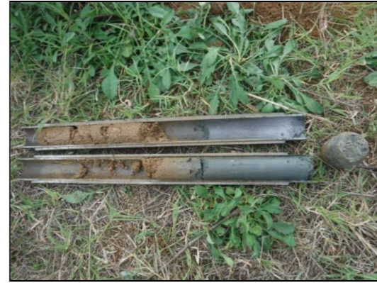
Foto 8: Sondeig S-5, SPT a 1,5 metres.
