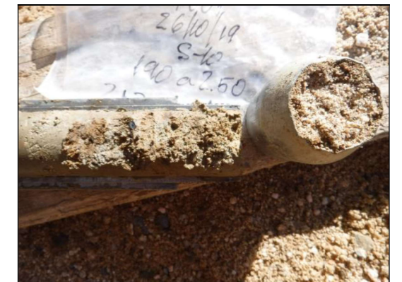
Foto 18: Sondeig S-10, SPT a 1,9 metres.
