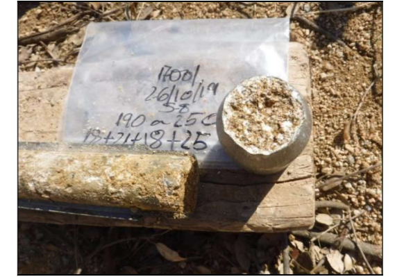
Foto 14: Sondeig S-8, SPT a 1,9 metre.
