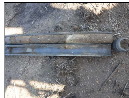
Foto 5: Sondeig S-3, SPT a 1,0 metre.
