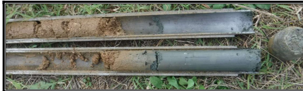
Aspecte d'un assaig SPT on s'aprecien els nivells més granulars (color marró) i els nivells amb més presència de fins (color gris).
